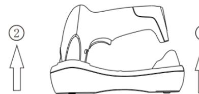
Extraiga la cola del escáner de la ranura de carga en la dirección de la flecha 1 y, a continuación, extraiga la cabeza del escáner.
