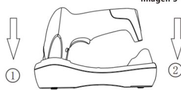
Inserte la cabeza del escáner en el compartimento de la cabeza de la base según la dirección de la flecha 1 y, a continuación, inserte la cola del escáner en la ranura de carga según la dirección de la flecha 2.
