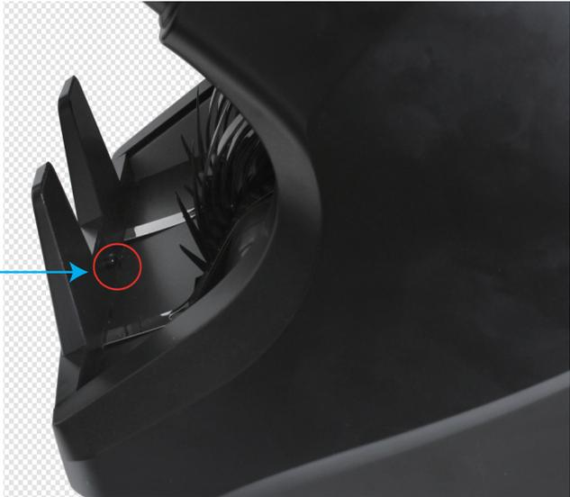
Figura 7-4 Sensores del apilador
