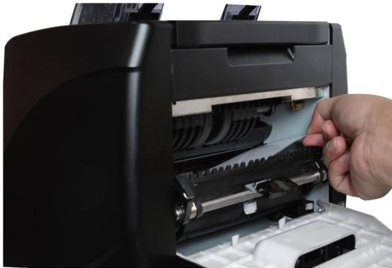
Figura 7-24 Colocar el papel de calibración CIS
