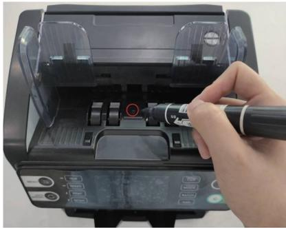
Figura 7-30 Utilice un rotulador para disminuir la sensibilidad del sensor de la tolva
