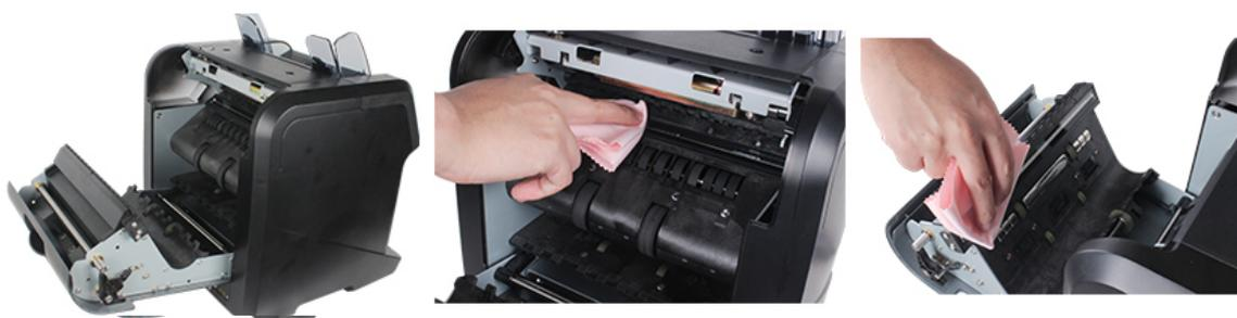
(4) Coloque el papel de calibración CIS (papel blanco) en el interior y cierre la cubierta posterior.
