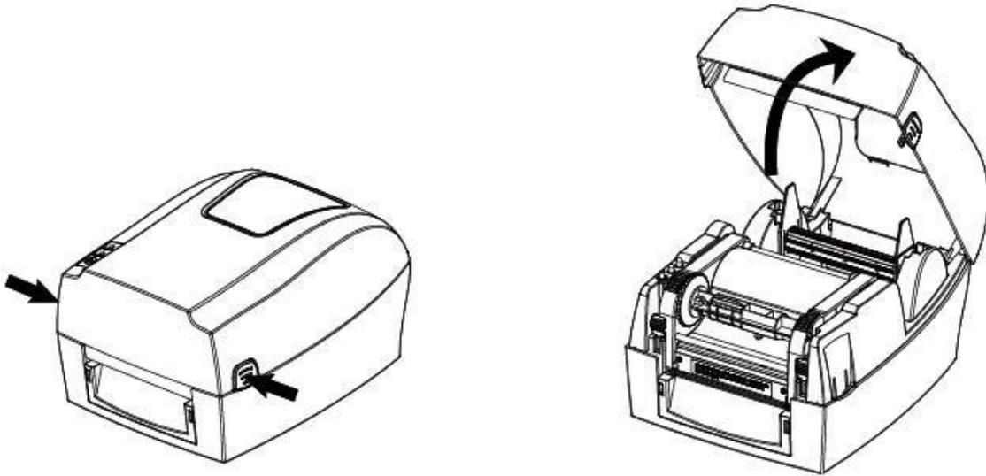
2. Suelte los pestillos y levante el mecanismo de la impresora.
