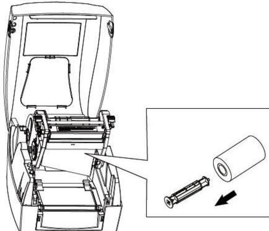
2. Después de poner el Core de cartón en el eje, inserte el lado izquierdo del módulo de rebobinado en la rueda de rebobinado y, a continuación, inserte el lado derecho en la ranura superior.
