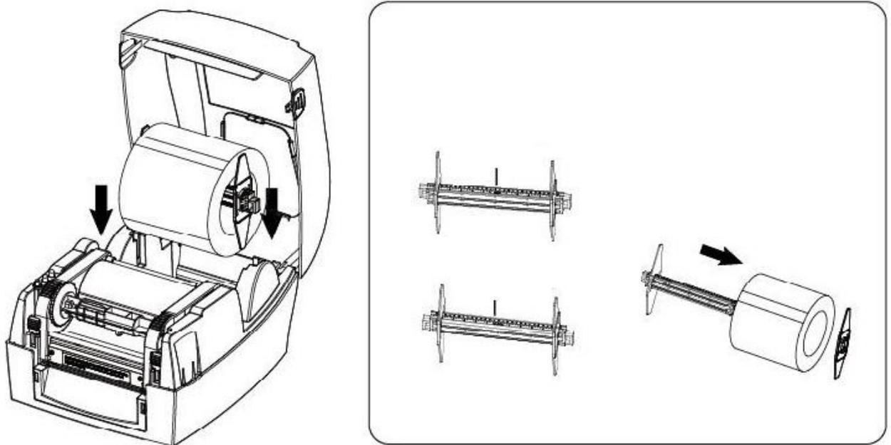
4. Levante el mecanismo de la impresora. Luego de pasar las etiquetas a través de las guías ajústelas para el ancho de la etiqueta.
